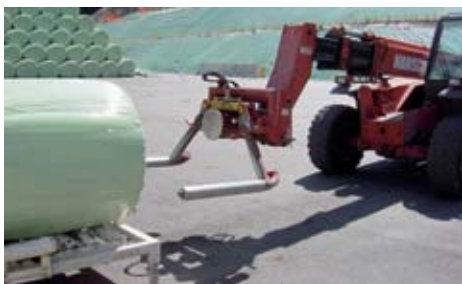
Der fertige Rundballen - Handhabung mit Teleskopstapler
