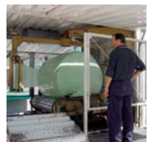
Wicklung der kompletten Oberfläche des Ballens
